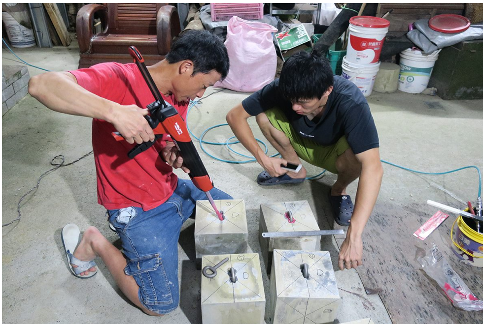
登榮將 Bolt 安裝於測試塊上
